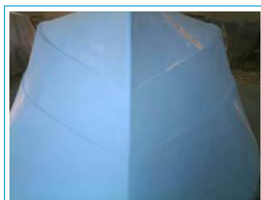
DD-28(8.5m)漁船 左右対称になっていないのが分かります
