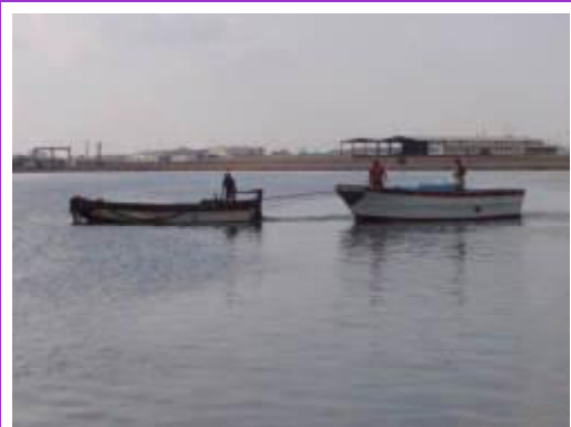
向かって左側:チュニジアのFRP船(木の船をそのままFRPにしただけ) 向かって右側:日本式FRP船(長さほぼ同じでも、一回り大きい)
